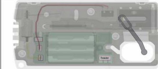
Скандинавська врізка. Важіль встановлений маркуванням 30.7 вниз.
