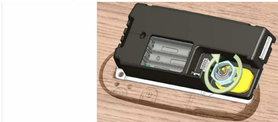
Встановлення гайки M19.
