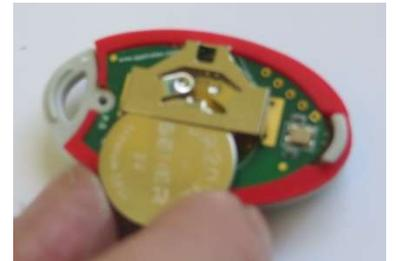
3. Закройте крышку, вставив язычок крышки под углом.
