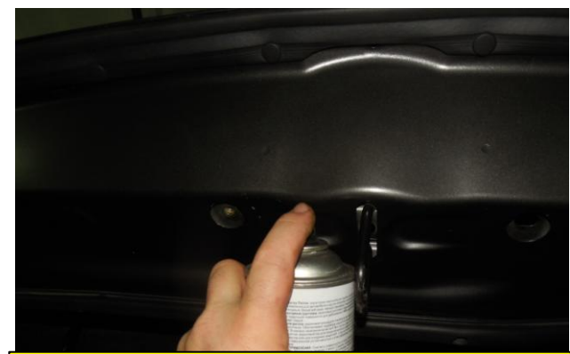
ОБРОБИТИ ОТВІР АНТИКОРОЗІЙНИМ ЗАСОБОМ
