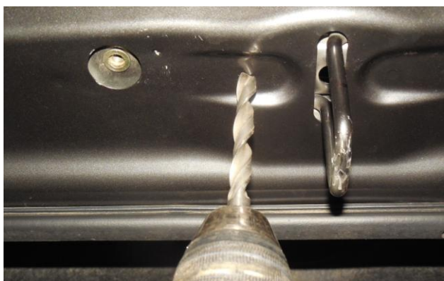
ПРОСВЕРДИТИ ОТВІР Ø 9 mm
