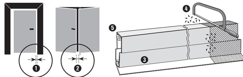
Dichtung kürzen im **ausgelösten Zustand**:
