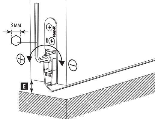
Einstellen Hub mit Inbusschlüssel (3 mm), Bodenanpressung vermeiden! (siehe Dichtungshöhe **E**), Funktionskontrolle
