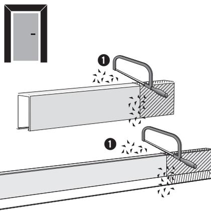
① Überströmkanal / Dichtung kürzen, Späne entfernen;
