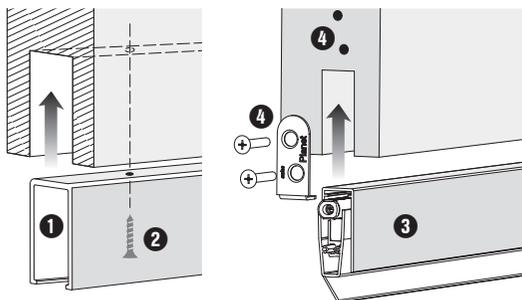
**Montage:** ① MinE-Kanal einsetzen; ② festschrauben (vorbohren), evtl. zusätzlich mit Montagekleber verkleben; ③ Planet einsetzen; ④ beidseitig mit Haltewinkeln befestigen (vorbohren).
