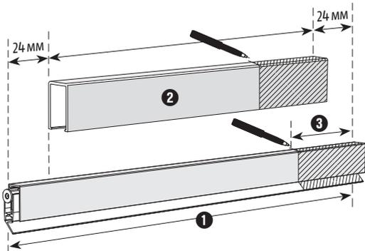
Vorbereitung zum Kürzen: ① Dichtung 1–2 mm kürzer als Türbreite; ② Kanal standardmäßig 48 mm kürzer als Dichtung; ③ Kürzmass: bis zur nächsten Lagerlänge (max. 125 mm)
