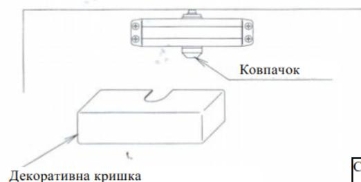
Примітка: Фіксатор відчиненого положення не повинний використовуватись на протипожежних дверях
