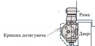
**A** Приєднати тягу до дотягувач під кутом 45° від полотна дверей, як показано нижче з використанням шайби та гвинта. Встановити дотягувач на двері гвинтами регулювання швидкостей у напрямі навісів.
