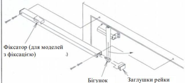
**B** Вставити фіксатор відчиненого положення до рейки, як показано нижче. Приєднати фіксатор до рейки гвинтами. (Тільки для моделей з фіксацією відчиненого положення).
