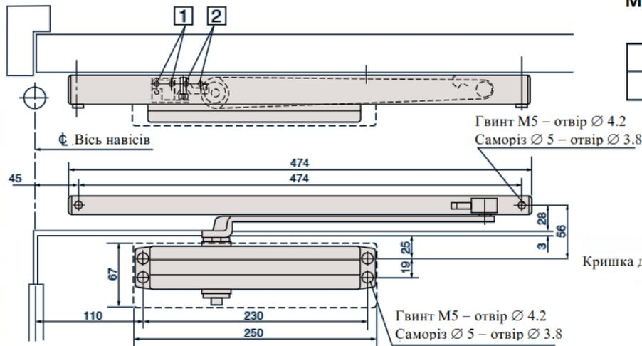
**Максимальний кут відкриття дверей – 120°**
