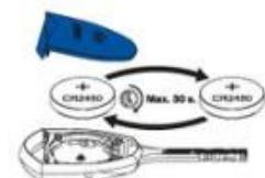
2. Витягніть елемент живлення та встановіть новий з дотриманням полярності. Якщо елемент живлення був відсутній в ключі більш ніж 30 секунд, після його заміни необхідно здійснити оновлення (Update) ключа через додаток CLIQ Connect смартфону.
