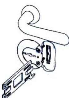
4. Вставити інструмент в отвір з комбінаційною карткою до клацання фіксатора картки.
