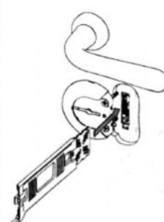
3. Перевірте замок з новими ключами. Заново перекодований замок може приводитися в дію тільки новими ключами. Поверніть пластикову кришку на місце. (див. малюнок)
